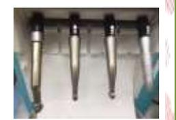
②洗ったハンドピースに空気を通してオイルを差します。内部も洗浄します。
